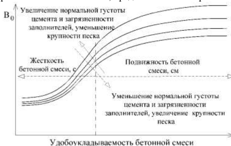
Рисунок 1 - Зависимость начальной водопотребности бетонной смеси (V 0 ) от ее удобоукладываемости
