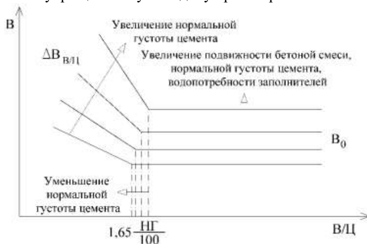
Рисунок 2 - Зависимость водопотребности бетонной смеси (V) от водоцементного отношения (V/Ц)
