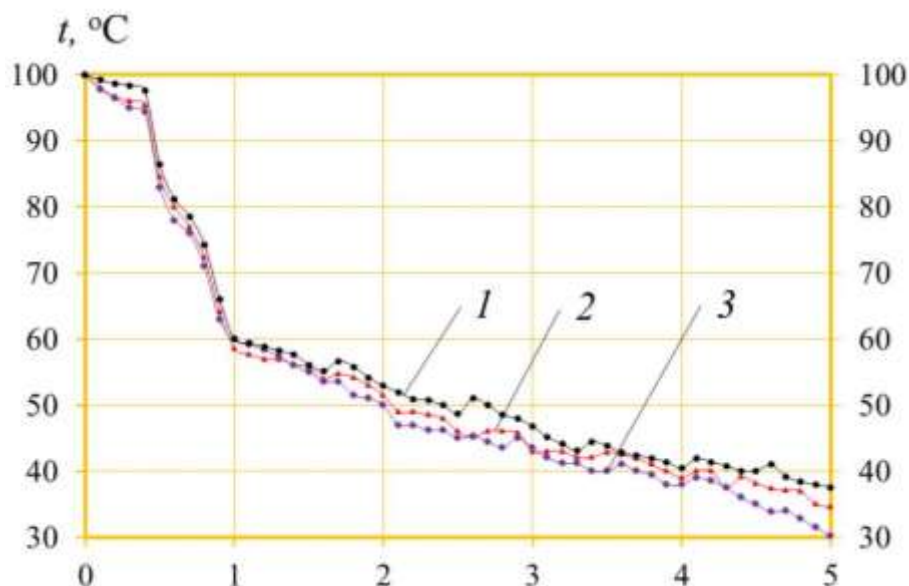
2-расм. Ўғит ҳароратининг ўзгарувчи омилларга ва барабан зоналарига боғлиқлиги
