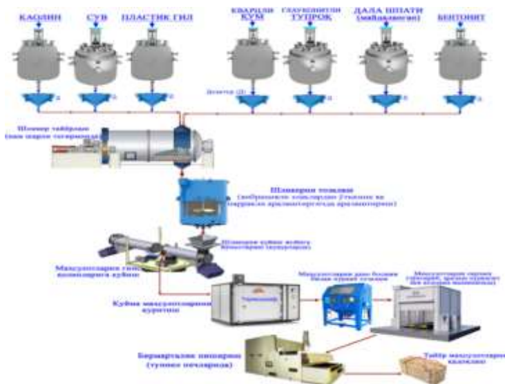
4-расм. Керамик композицион масса асосида санитар-курулиш махсулотларини ишлаб чикаришнинг технологик схемаси
