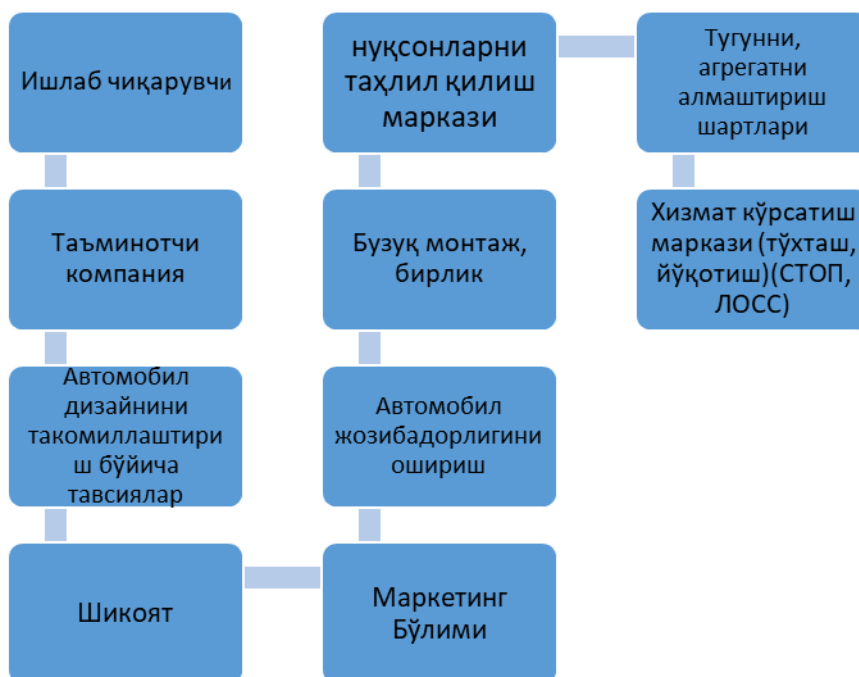
1-шакл Кафолат муддати давомида автомобилнинг носозликлари ва нуқсонлари тўғрисида маълумот узатиш схемаси
