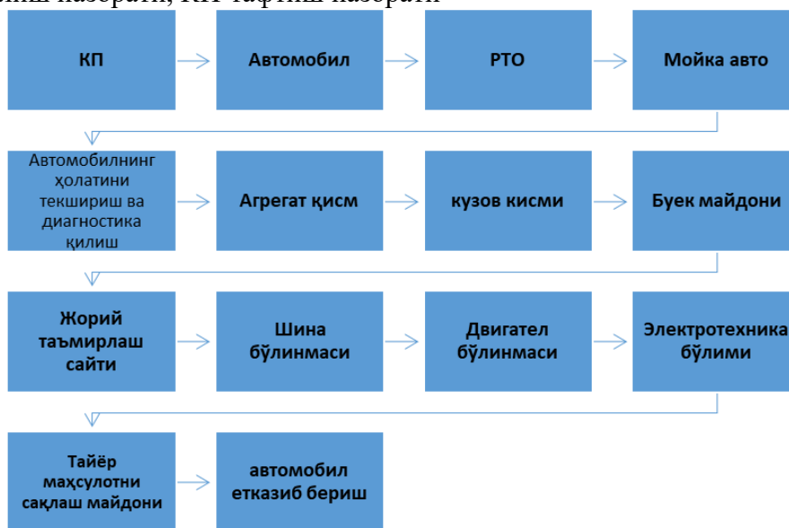
2-шакл. Кафолатли даврда автомобилларга техник хизмат кўрсатиш ва таъмирлаш технологик жараёнининг блок диаграммаси
